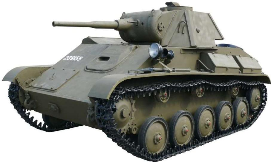
**T-70 — Ikkinci jahon urushi davridagi engil sovet tanki. 1941 yilning oktyabr-noyabr oylarida Gorkiy avtomobil zavodida ishlab chiqarilgan. Quronishiga 1942 yilning yanvar oyida qabul qilingan.**
